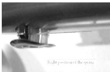
Giusta posizione della molla Right position of the spring
