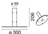
Bodenmastfuß 60mm- Geeignet für H-3m Mast
