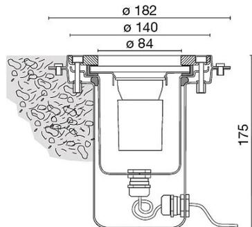
Esempio di installazione in vasche con guaina in PVC
