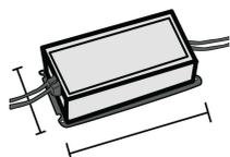
ANTRIEBSGERÄT EIN-AUS 230/24Vdc 100W IP67
