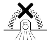
Apparecchi non idonei ad essere ricoperti da materiale termicamente isolante.
